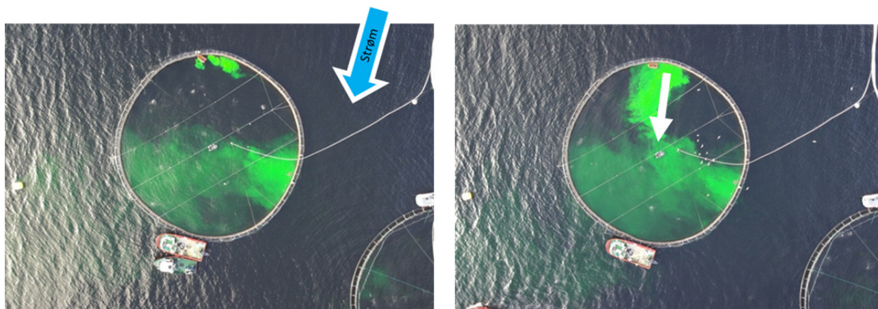
Figur 17. Fargestoff pumpet ut på oppstrøms side inne i en merd med skjørt.
